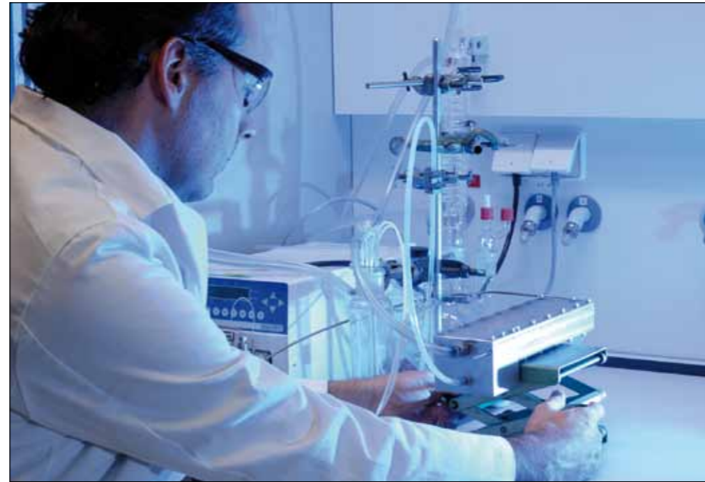
Éénstaps microfractioneringssysteem op labschaal dat wordt doorontwikkeld tot een horizontaal microdestillatiesysteem, dat op termijn energie-surpluse destillatiekolommen kan vervangen.
