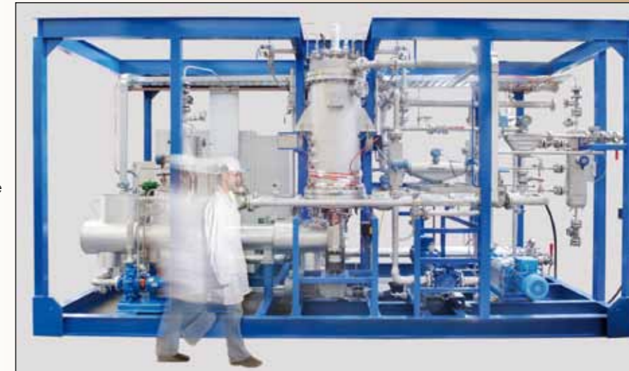
Pilotplant van een Hydraulische Was Kolom voor het ultra-zuiveren van chemicaliën met gebruik van zeer weinig energie en afvalproductie.
